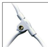
**10 stecche diametro 5** in acciaio zincato a caldo e rivestite con vernice a polvere epossidica di alta qualità, ricavate da un filo di acciaio armonico. La giunzione fra stecca corta e lunga avviene mediante un lamierino di ottone. Protezione della giunzione tramite ovale in tessuto Sky.
